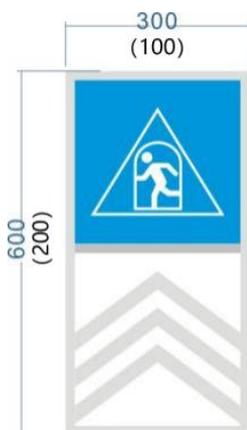
图 5-6 地下室地面导引标牌样式示意
