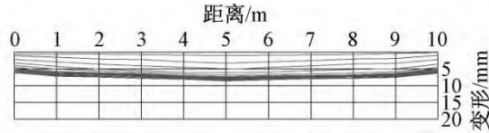
图 6-2 管道变形曲线
